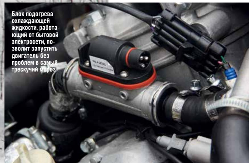
Блок подогрева охлаждающей жидкости, работающий от бытовой электросети, позволит запустить двигатель без проблем в самый трескучий мороз
