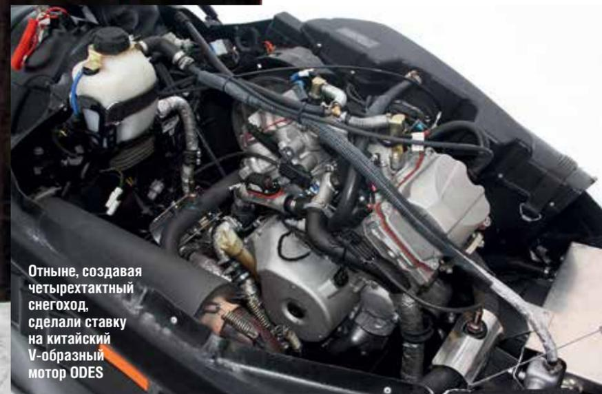
Отныне, создавая четырехтактный снегоход, сделали ставку на китайский V-образный мотор ODES
